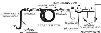
**ATTENTION :** Assurez-vous que le système d'air est entièrement purgé et que le compresseur soit éteint avant de brancher le filtre régulateur.
