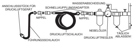
**WARNUNG!** Schalten Sie stets den Kompressor aus und machen Sie das Druckluftsystem drucklos, bevor Sie die Wartungseinheit anschließen.
